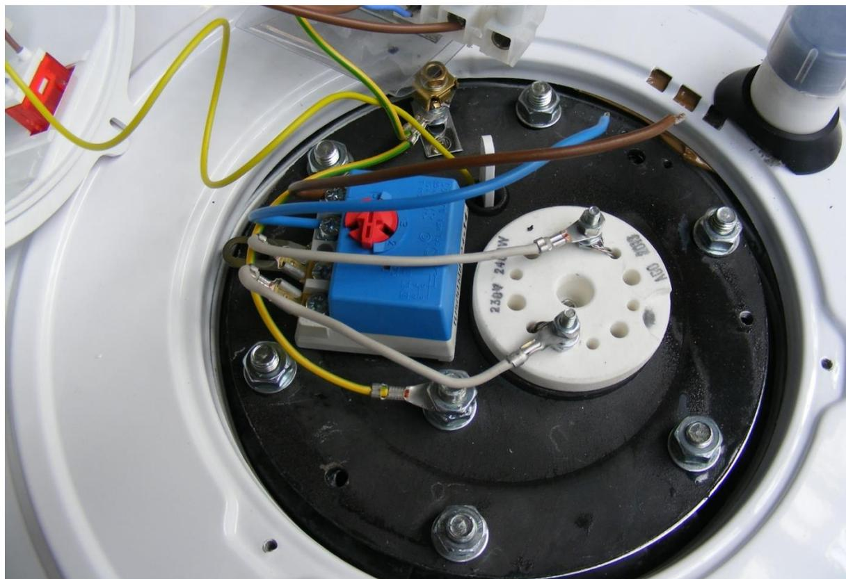
3. С помощью винта закрепить пластину, удерживающую ТЭН.
