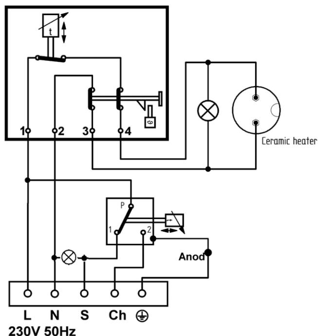
При таком подключении термостат бойлера управляет нагревом от основного источника тепла, например, управляет насосом нагрева бойлера.
