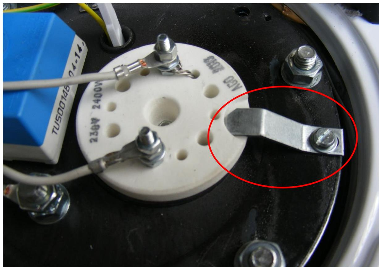
4. С помощью винта закрепить пластину, удерживающую терморегулятор.
